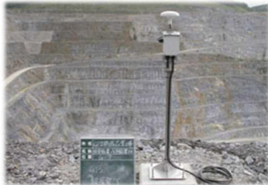
「SHAMEN-NET」は、GPS自動計測システムを用いて地盤や構造物の変位をリアルタイムに3次元・mm単位で計測し、専任技術者が計測変位を24時間365日監視する維持管理支援サービス
